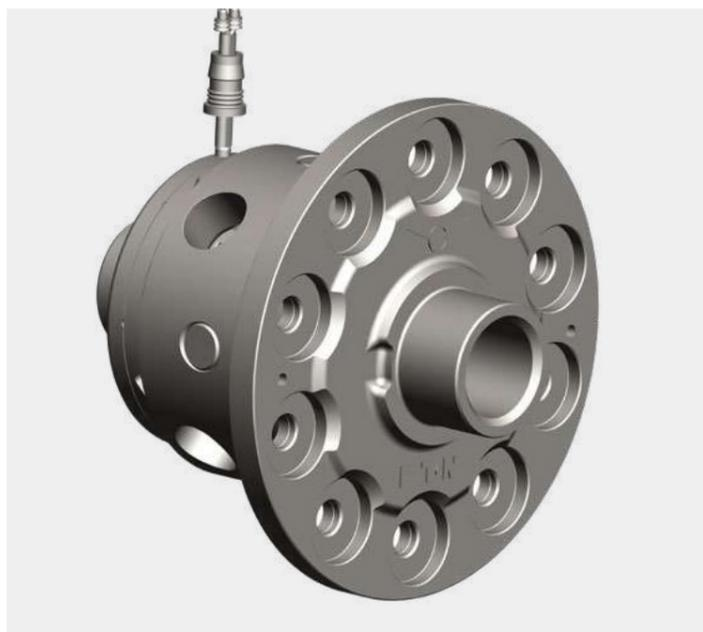
Блокировка дифференциала позволяет установить жесткую связь между колесами одной оси, что исключает остановку одного ведущего колеса, когда второе буксует. Тем самым повышается проходимость автомобиля на бездорожье. Блокировка управляется специальной кнопкой в салоне автомобиля.
